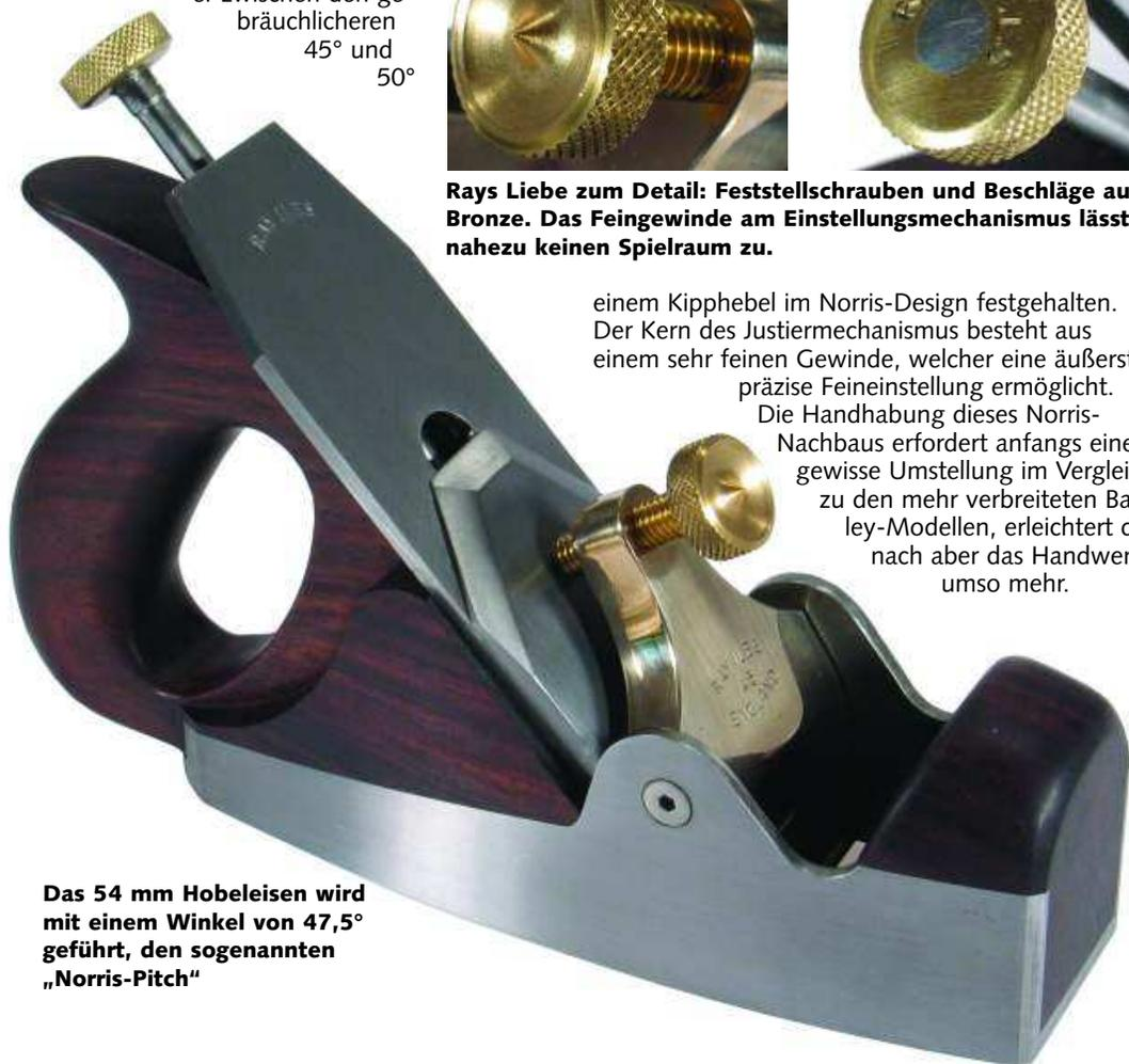
**Das 54 mm Hobeisen wird mit einem Winkel von 47,5° geführt, den sogenannten „Norris-Pitch“**
